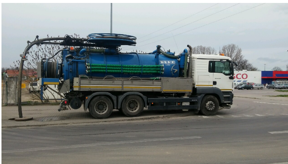
Zdj. Wóz asenizacyjny przy studzience kanalizacyjnej
